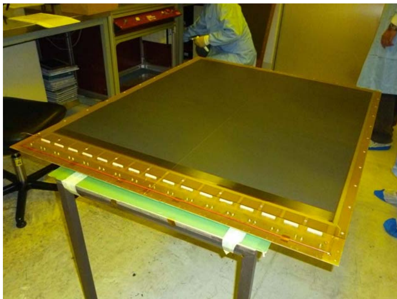
Рисунок 58 - Прототип камеры Micromegas размером 1x1 м 2 который был испытан на пучке частиц
