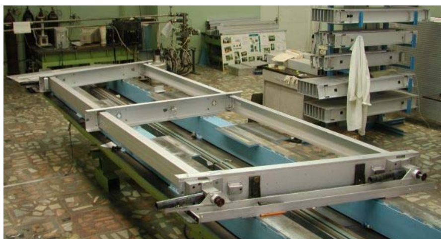
Рисунок А4 - Несущий конструктив дрейфовой камеры
