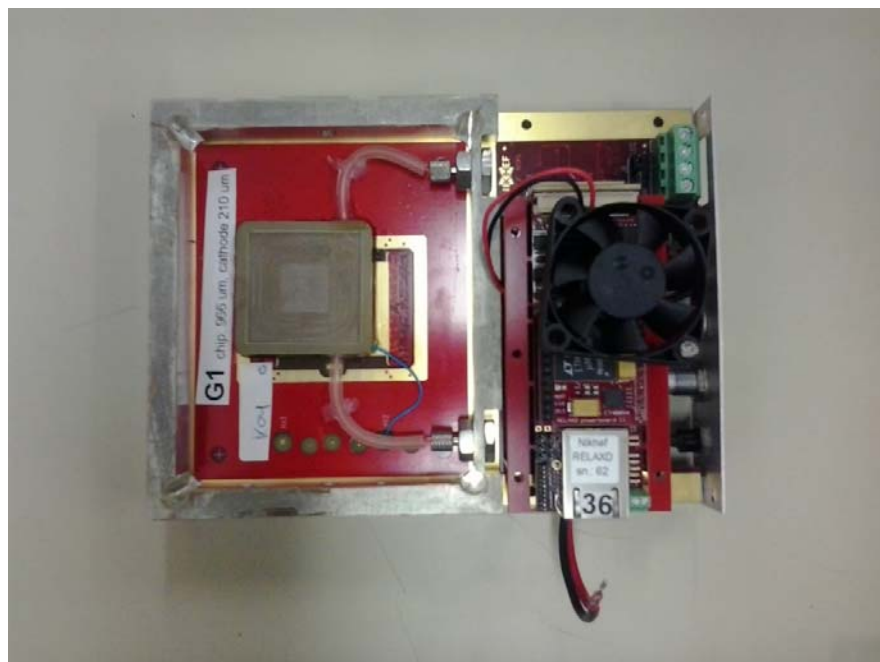
Рисунок 61 - Сборка одного из газо-пиксельных детекторов (слева) и считывающей электроники (с правой стороны)
