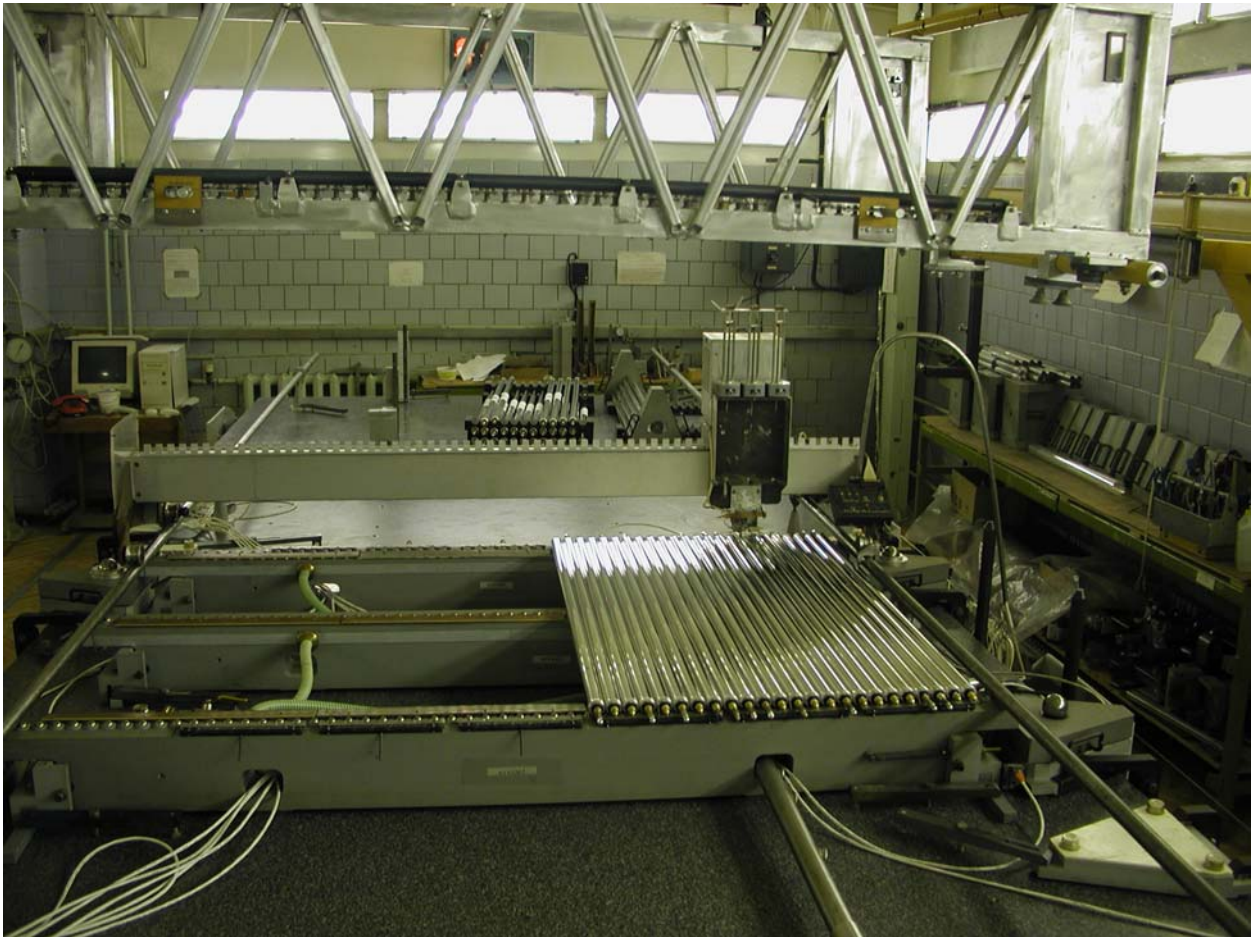
Рисунок 19 - Дрейфовые трубки на позиционирующих гребенках и клеераздаточная машина для послойной склейки
