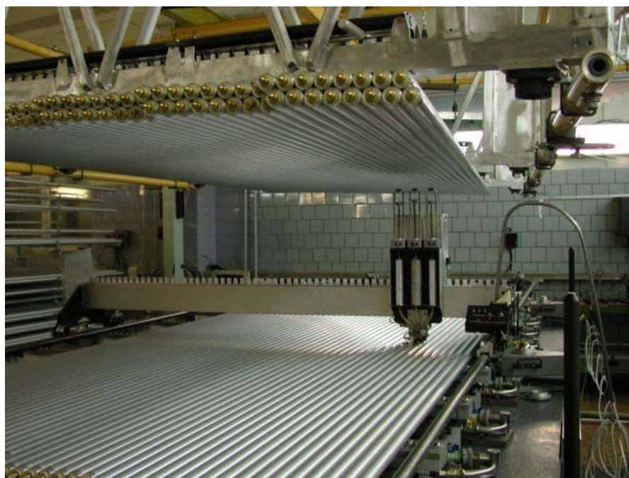
Рисунок А3 - Склейка 3-го слоя дрейфовых трубок. Траверса со склеенными 1-м и 2-м слоями – в верхнем положении
