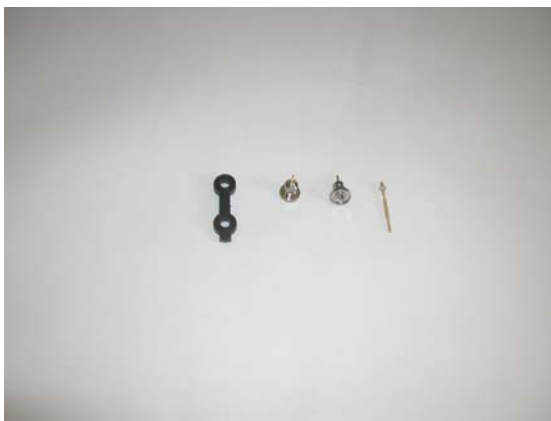
Рисунок 17 - Газовый переходник, контактные колпачки и заземляющий штырь
