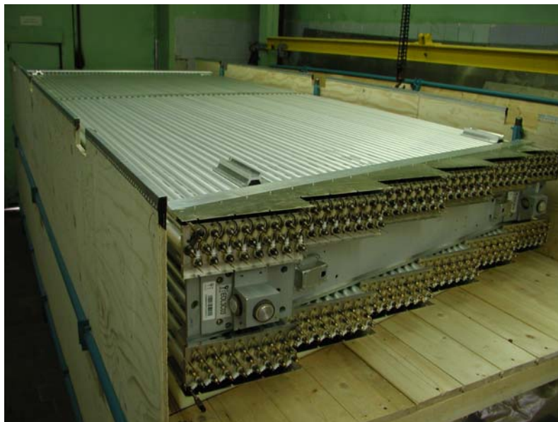
Рисунок А6 - Дрейфовая камера, упакованная в ящик с поролоновой подстилкой
