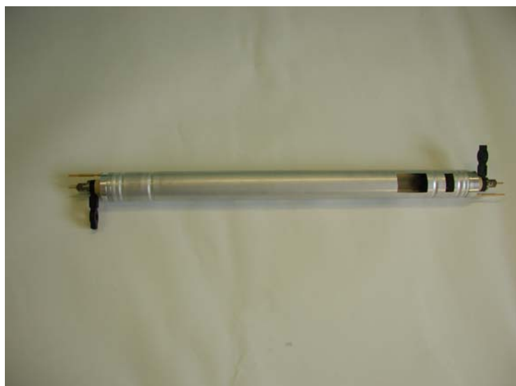
Рисунок 18 - Усовершенствованный экспериментальный образец дрейфовой трубки в сборе с газовыми переходниками, контактными колпачками и заземляющими штырями
