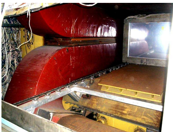
в) Фото магнита и пропорциональных камер в магните
