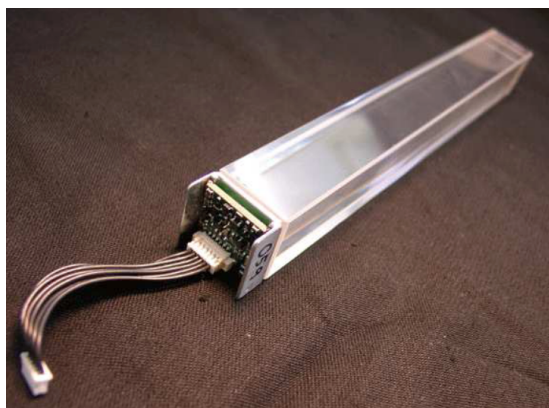
Рис. 2.2: Одна детектирующая ячейка фотонного спектрометра PHOS, состоящая из кристалла \text{PbWO}_4 и лавинного фотодиода с предусилителем (слева). Общий вид PHOS согласно проекту (справа).
