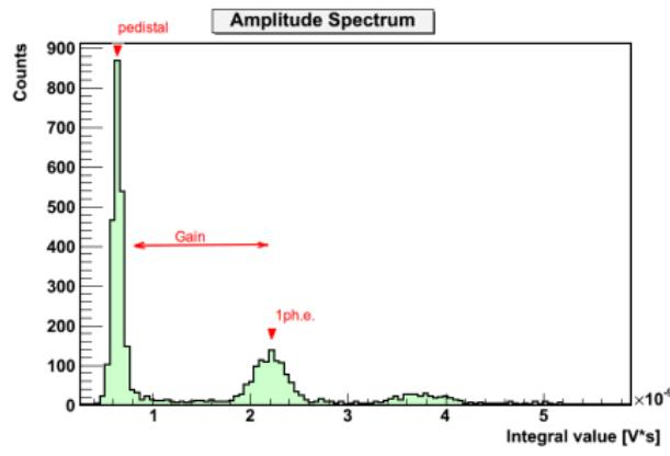
$gain_{pixel}$  найден из проинтегрированного сигнала SiPM:
