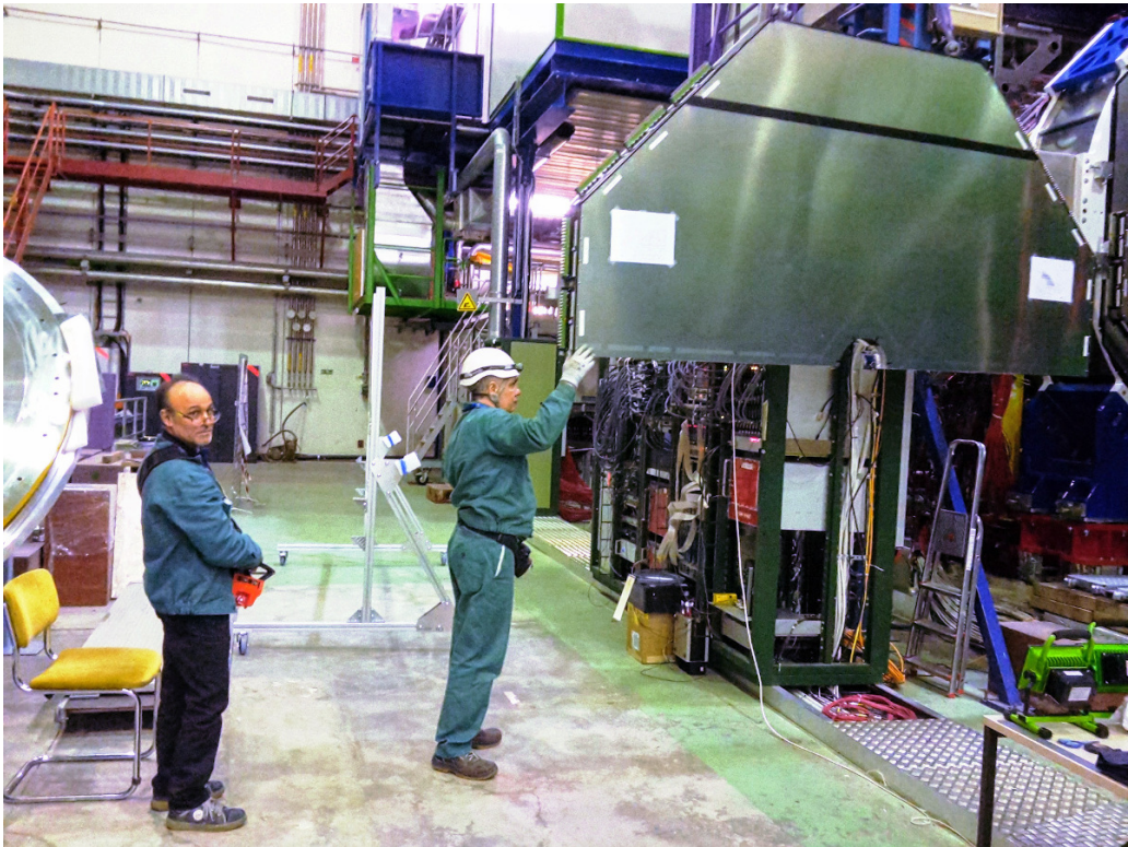
Рисунок 1.33: Фотография нижней половины годоскопа без светоизоляции.
