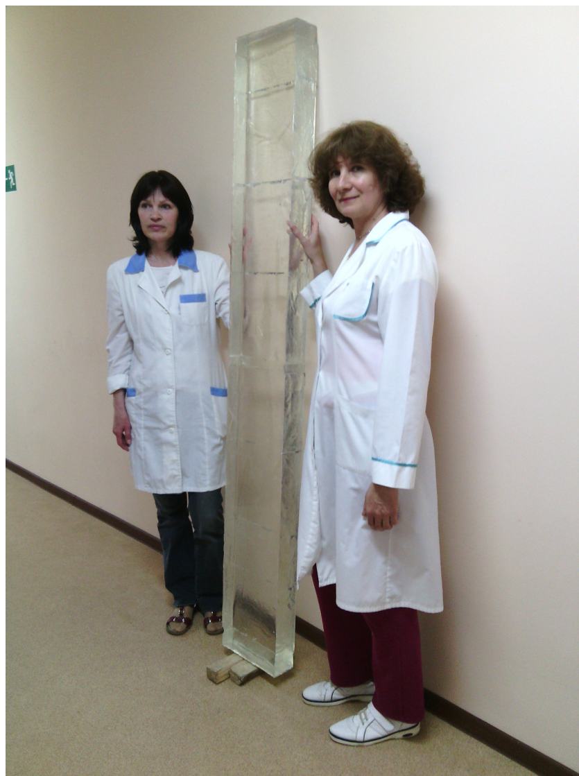
Рисунок 1.30: Один из трех блоков сцинтиллятора изготовленный в НИЦ «Курчатовский Институт» —ИФВЭ для годоскопа CHOD.
