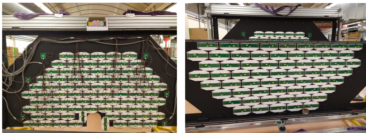
Рисунок 1.42: Верхняя часть детектора в чистой комнате после установки всех счетчиков и подключения сигнальных кабелей и шлейфов питания.
