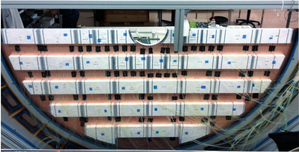
Рисунок 1.33: Фотография нижней половины годоскопа без светоизоляции.
