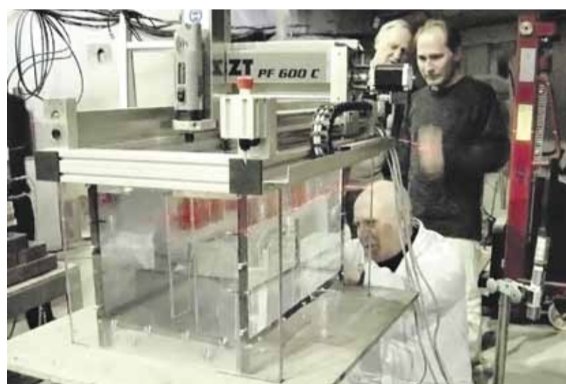
Юстировка образцов биообъектов в водном фантоме в зоне ВРБС
